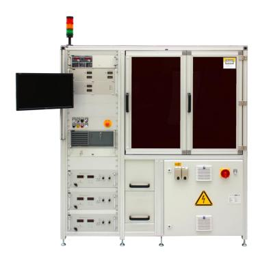
Dabei werden die Leistungshalbleiter einerseits mit einem hohen Strom in Flussrichtung beaufschlagt, in einer anderen Phase werden die gesperrten Leistungshalbleiter mit einer hohen Sperrspannung getestet.
